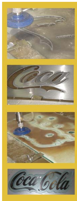
Letrero publicitario cortado con waterjet en acero inoxidable de 1mm. de espesor y vidrio de 10mm. (puede ser lustrado por mucho más tiempo sin rayarse).
