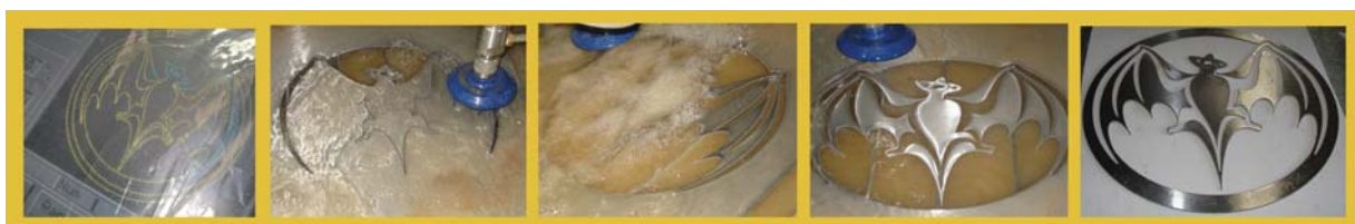
Proceso de corte en acero inoxidable de una marca comercial.
